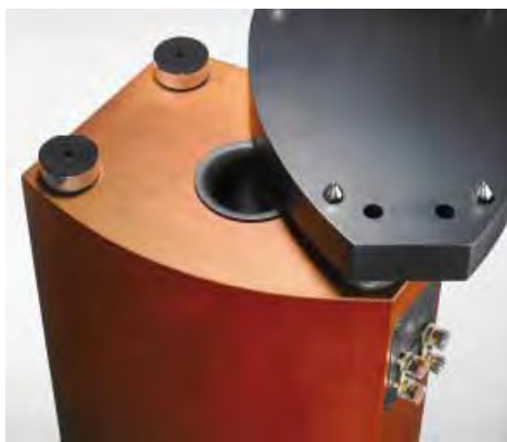
Das Bassreflexrohr mündet zwischen Korpus und Sockel. Die bodennahe Anordnung bringt mehr Tiefbass, ohne die Chassis zu belasten.
